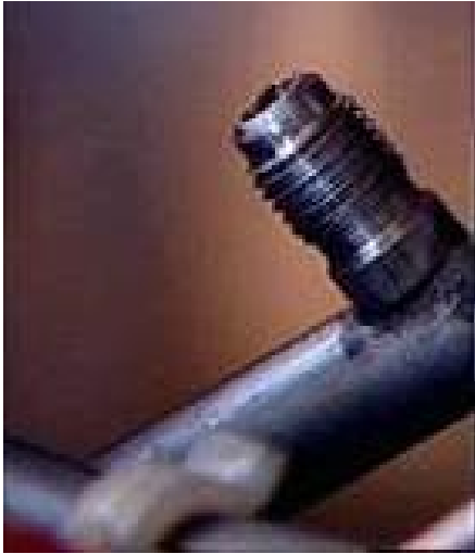
R12 制冷剂使用的螺纹加注制冷的设备
